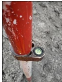
Gambar 8 Centering Nivou pada Stick Prisma
