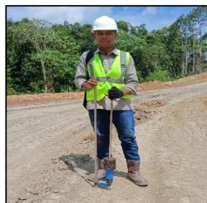
Gambar 2. Pengambilan Data CBR Lapangan Menggunakan Alat DCP
