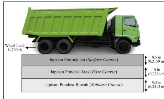
Gambar 4. Perencanaan Tebal Perkerasan Jalan dengan Harga CBR
