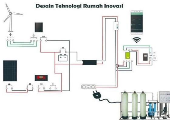
Gambar 1. Mesin pengolahan air minum tenaga Hybrid Solar Cell dan Turbin Angin dengan control android
