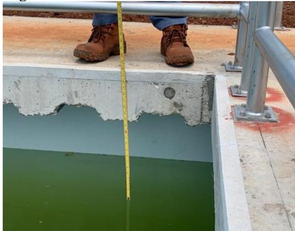
**Gambar 6 Pengukuran level air**
